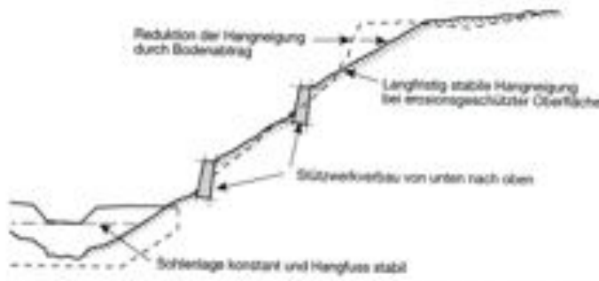
Abb. 5. Hangverbau mit Stützwerken nach erfolgter Stabilisierung der Gerinnesohle Q: Böll 1997: 103
